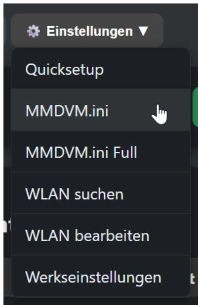
Unter Einstellungen stehen diverse Funktionen zur Verfügung. Hier kann z.B. die MMDVM.ini bearbeitet werden, ein weiteres WLAN hinzugefügt werden, oder aber der Hotspot auf Werkseinstellungen zurückgesetzt werden.
